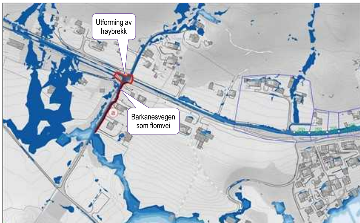
Figur 9.23 Sikring mot 200-års overvannsflom på sted a vest i Jørpeland (vanndybde scenario A 2.2).
