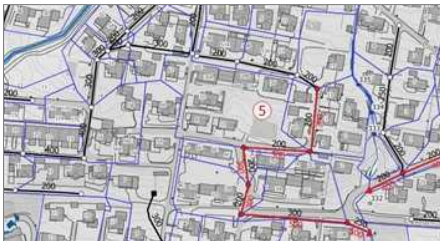
Figur 9.10 Tiltak i ledningsnettet på sted 5 i Elgstien og Elgvegen (vanndybde scenario A 1.1).
