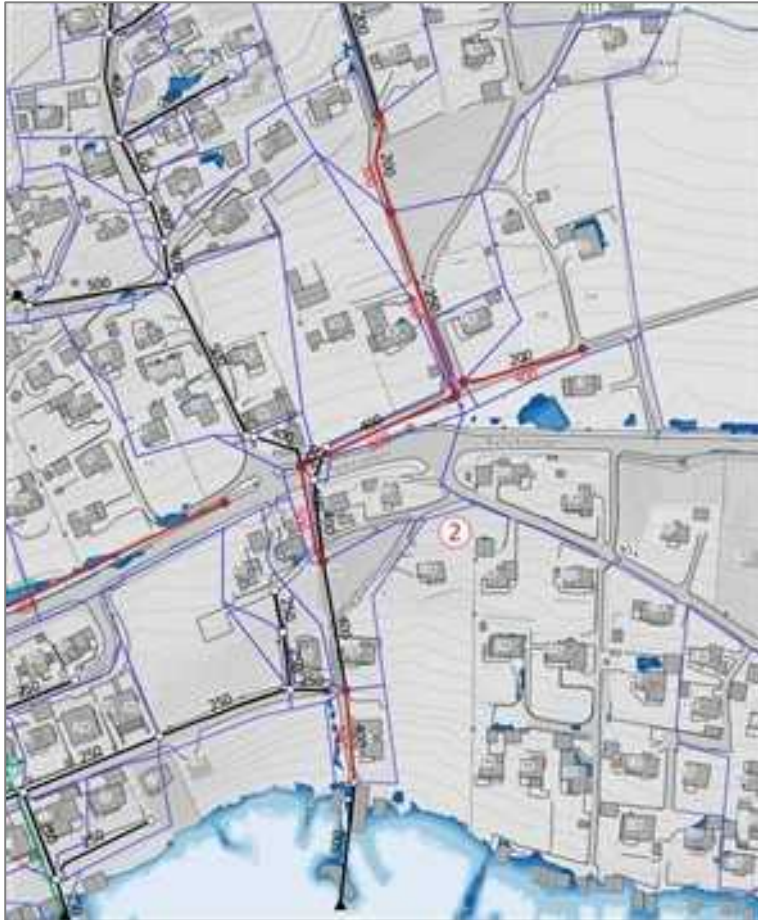
Figur 9.7 Tiltak i ledningsnettet på sted 2 vest i Jørpeland (vanndybde scenario A 1.1).
