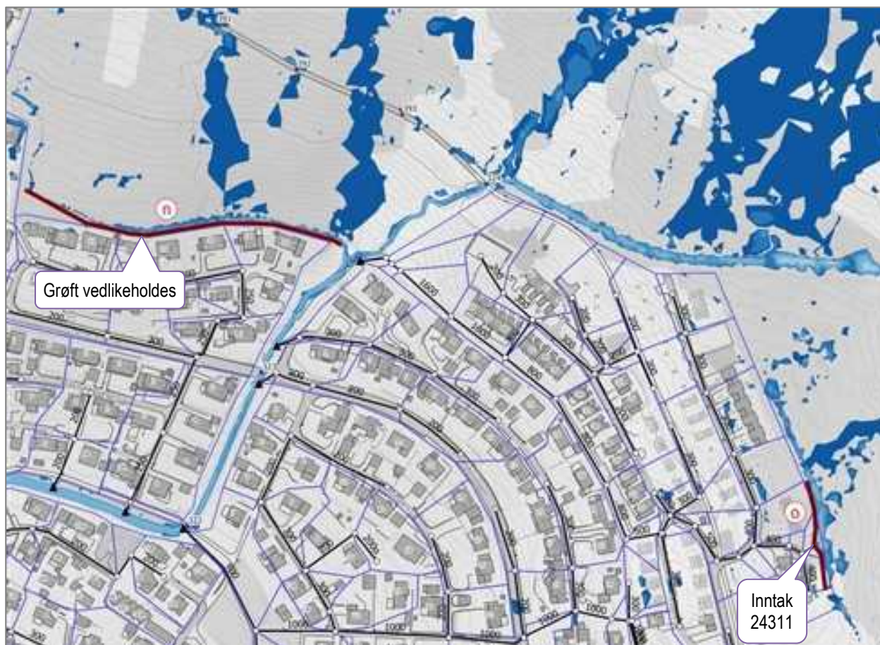
Figur 9.35 Sikring mot 200-års overvannsflom på sted n og o øst i Jørpeland (vanndybde scenario A 2.2).
