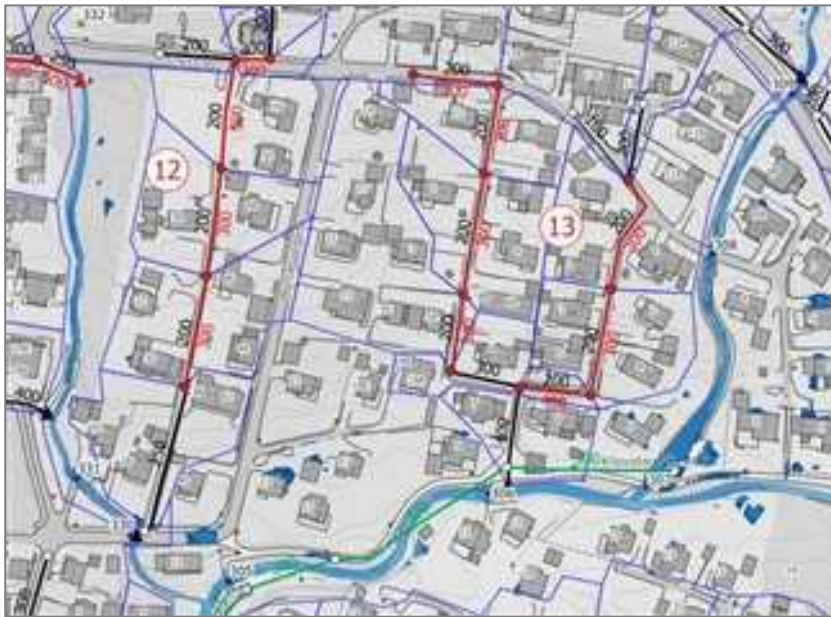
Figur 9.14 Tiltak i ledningsnettet på sted 12 og 13 (vanndybde scenario A 1.1).
