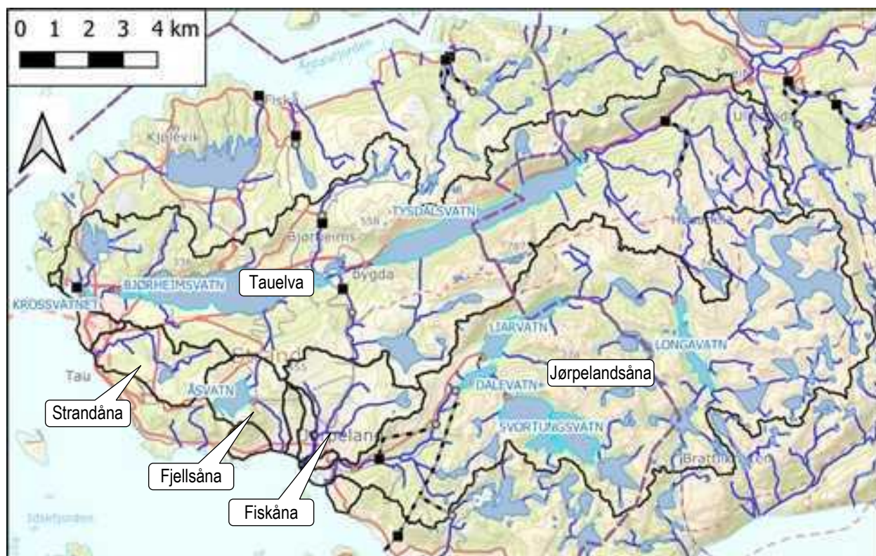
Figur 3.3 Oversiktskart over vassdrag i Tau og Jørpeland. Nedbørfelt er vist med svart kant, magasiner med lyseblå kant, vannkraftverk med svart firkant, vanntunnel med stiplet svart-grå linje. Bakgrunnskart: Topografisk norgeskart, Kartverket; vannkraftdata: NVE.
