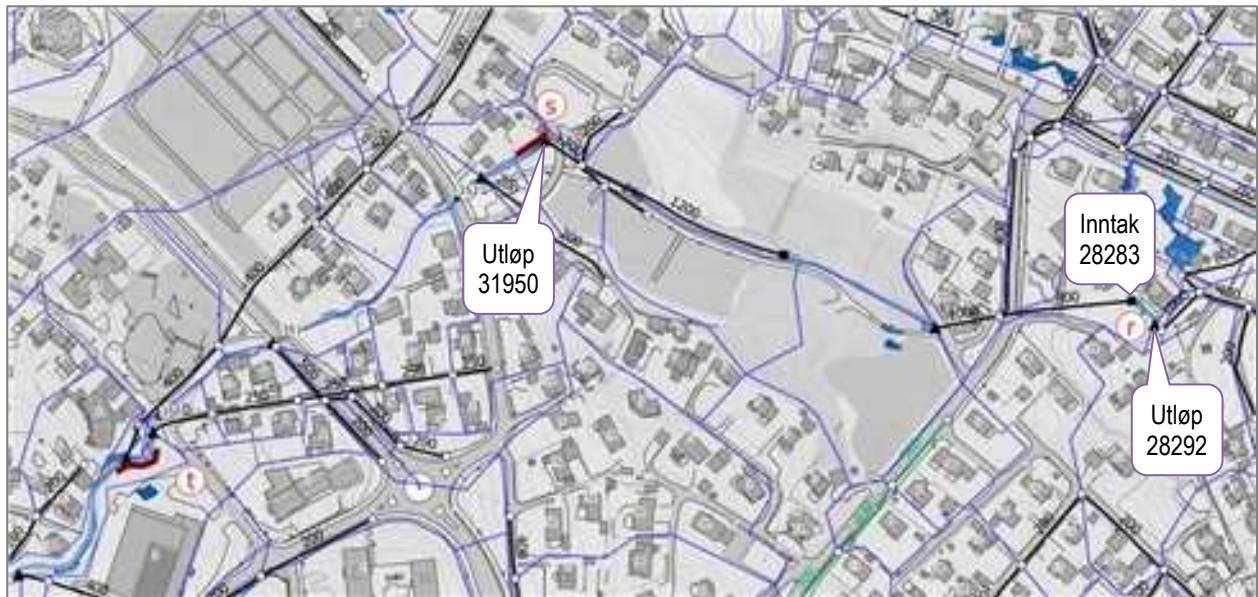
Figur 9.38 Sikring mot 200-års overvannsflom på sted r, s og t sentralt i Jørpeland (vanndybde scenario A 2.2).
