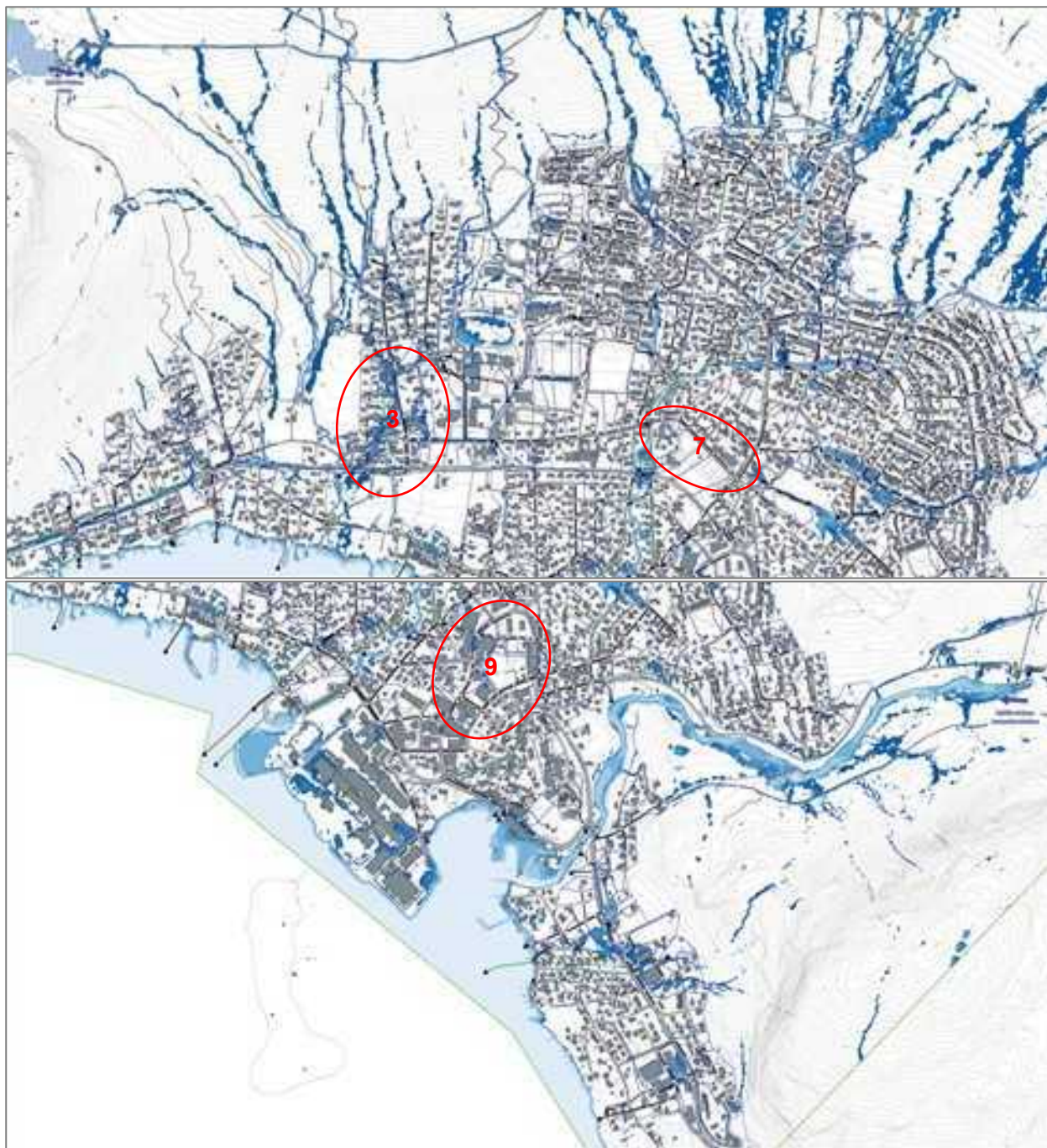
Figur 9.5 Utsnitt fra tegning H 114. Steder i Jørpeland med mindre flomareal (scenario B 0) sammenlignet med kortere varighet (scenario A 2.2, Figur 9.4): Nedrafjelle (3), Fjell-tunvegen (7) og sentrum (9).
