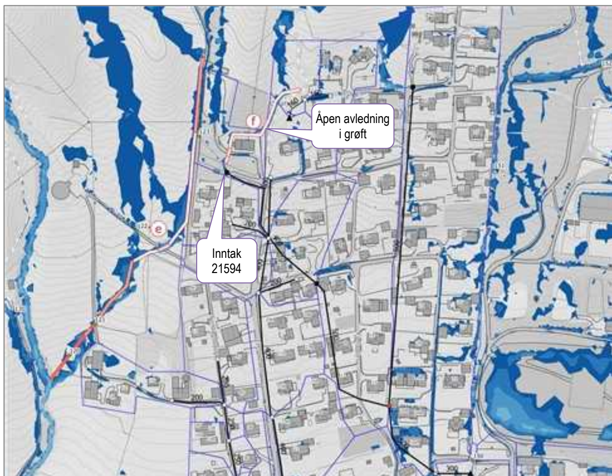
Figur 9.27 Sikring mot 200-års overvannsflom, alternativ løsning på sted f (vanndybde scenario A 2.2).
