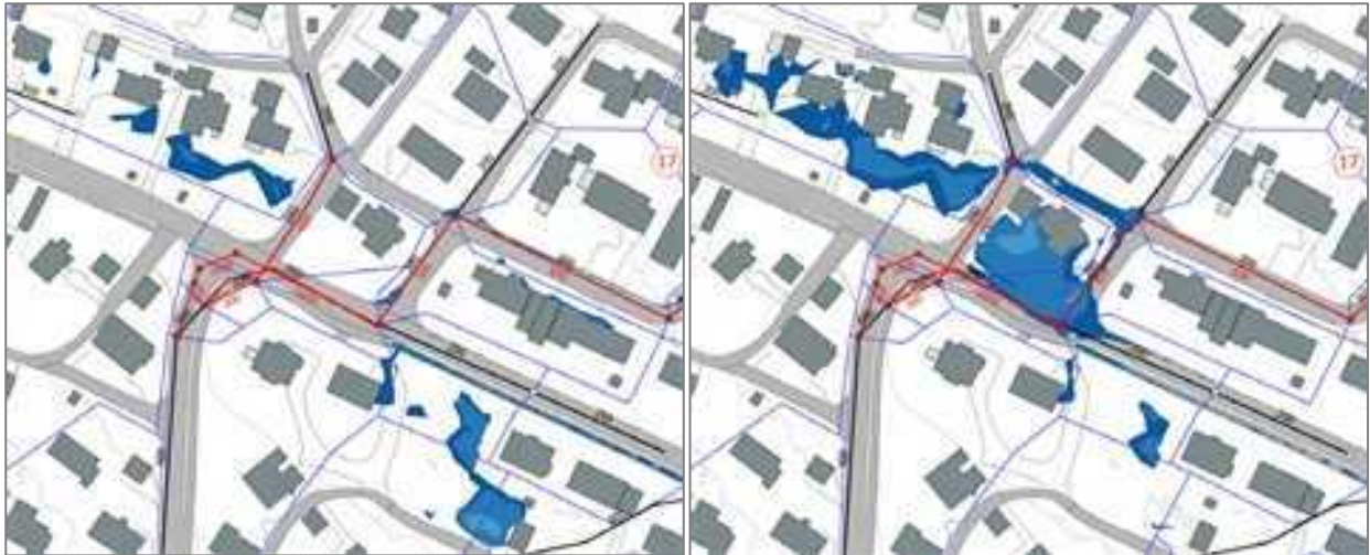
Figur 9.44 Flomareal i planlagt tilstand på sted 17 (Tulipanvegen) for scenario A 2.2 Q200 60min (venstre) og A 2.1 Q200 10min (høyre) før ytterligere tiltak (vanndybde scenario A 2.1).
