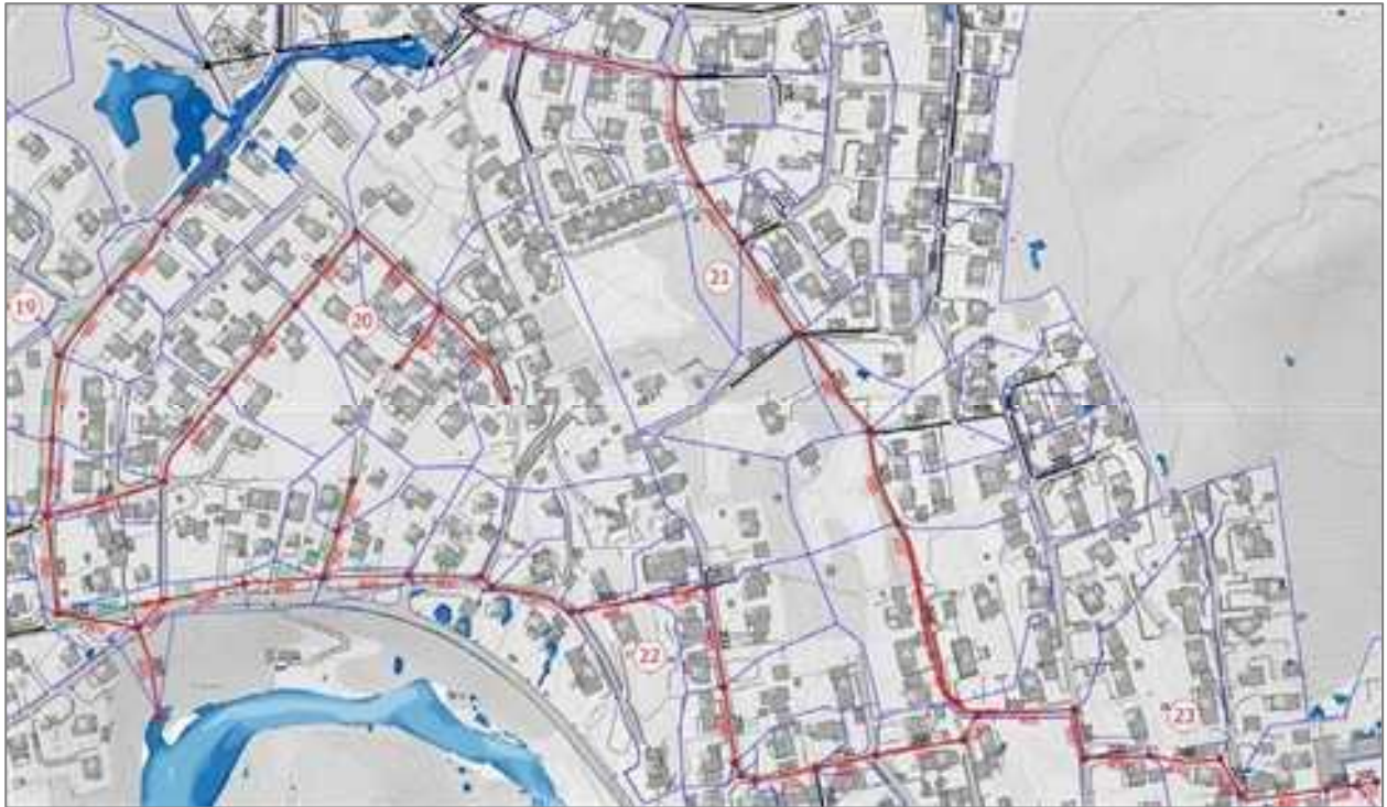
Figur 9.22 Tiltak i ledningsnettet på sted 19 til 23 sørøst i Jørpeland (vanndybde scenario A 1.1).
