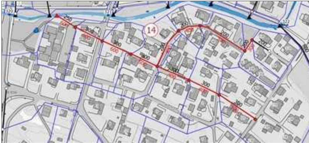
Figur 9.15 Tiltak i ledningsnettet på sted 14 i Jørpeland (vanndybde scenario A 1.1).
