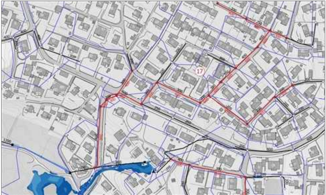
Figur 9.19 Tiltak i ledningsnettets på sted 17 sentralt i Jørpeland, alternativ B (vanndybde scenario A 1.1).
