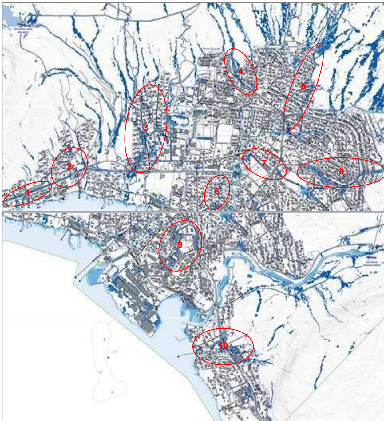
Figur 9.4 Utsnitt fra tegning H 111. Kritiske områder i Jørpeland ved 200-års overvannsflom med 60 minutters varighet (scenario A 2.2): Ryfylkevegen / Ole Th. Barkvedsveg (1), Spøtahaugen og Øvre Barkvedsvegen (2), Ovrå- og Nedrafjelle (3), Kvitemyrkroken og Hellandsvegen (4), Leitevegen (5), Nygårdsbakken (6), Fjelltunvegen og Skogstjernevegen (7), Blåfjærsvingen / Førlandsringen / Tulipanvegen (8) sentrum (9) og Tungland (10).
