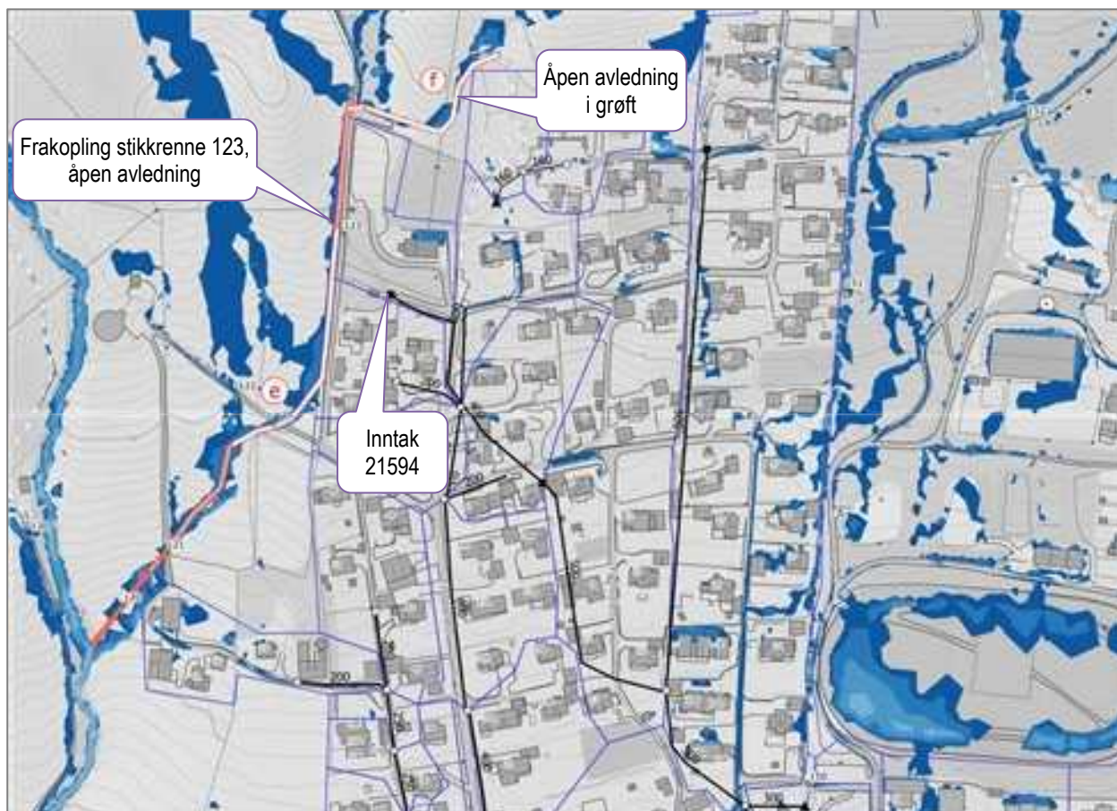
Figur 9.26 Sikring mot 200-års overvannsflom på sted e og f nordvest i Jørpeland (vanndybde scenario A 2.2).
