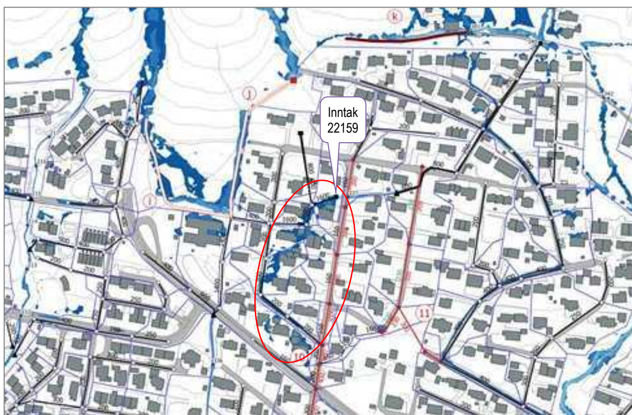
Figur 9.42 Vann på avveie som følge av oppstuvning ved inntak 22159 på Fjeldebakken i scenario B 0, uten tiltak ved den lukkede avledningen.
