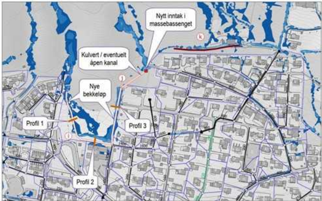
Figur 9 viser bilde av tiltak i, j og k fra rapport Overvannsplan med tiltaksbeskrivelse- flomsikringskonsept for Jørpeland og TAU og viser foreslåtte tiltak på vestsiden av områdeplanen.
