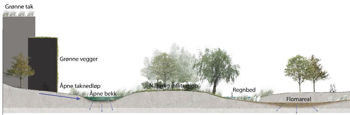
Figur 12 Lokale løsninger for overvann (Norsk vann 2008)
