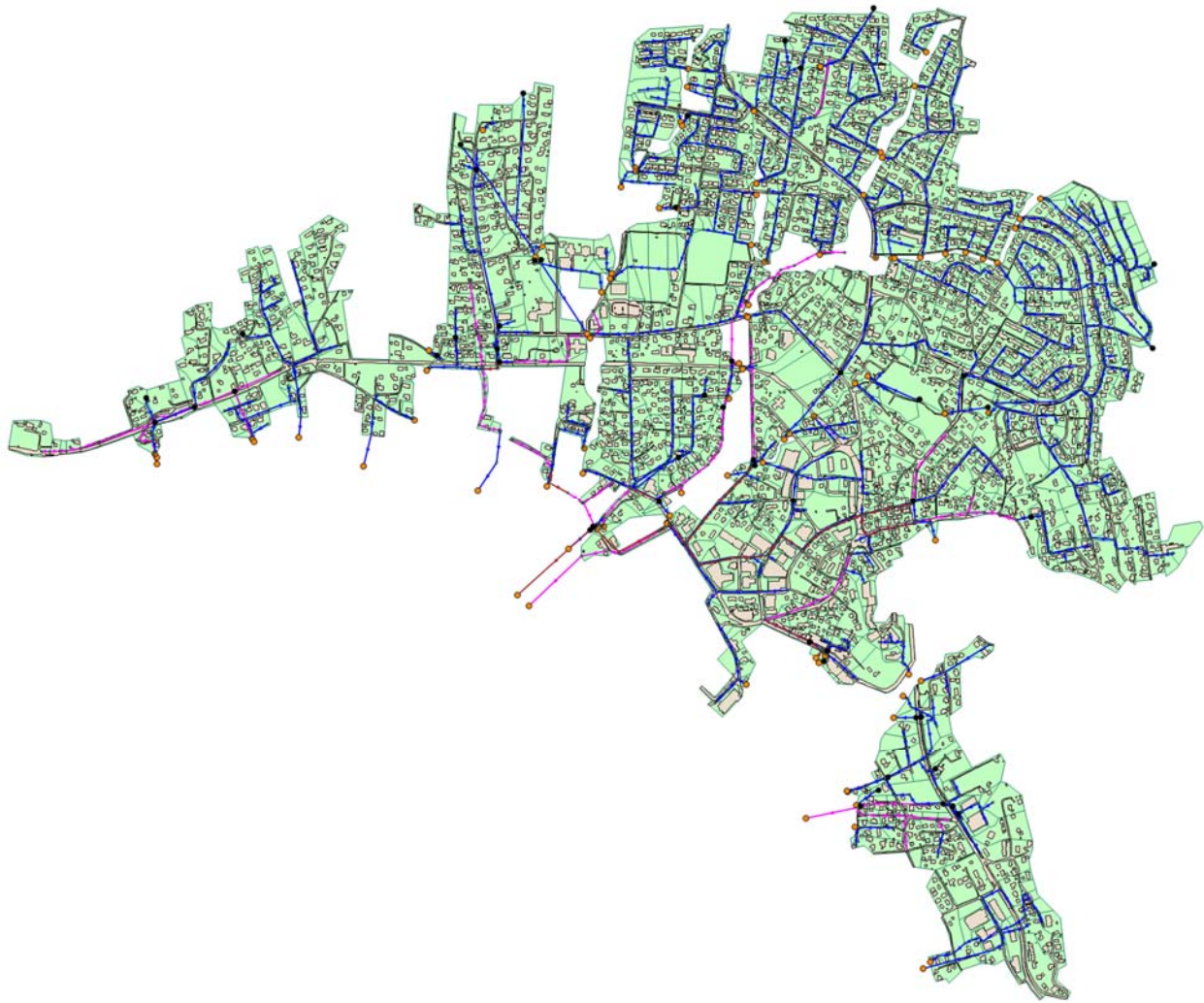
Figur 7.2 Oversikt over ledningsnettmodellen for Jørpeland. Overvannsledninger (blå), avløp felles ledninger (fiolett), spillvannsledninger (brun), utløp (gule prikker) og nedbørfelt til ledningsnettets delt inn etter permeable flater (grønn) og tette flater (rød skravur).
