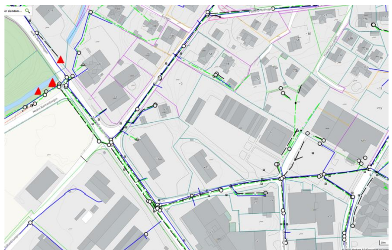
Figur 7 Utsnitt fra kartgrunnlag - Etablert infrastruktur for VA
