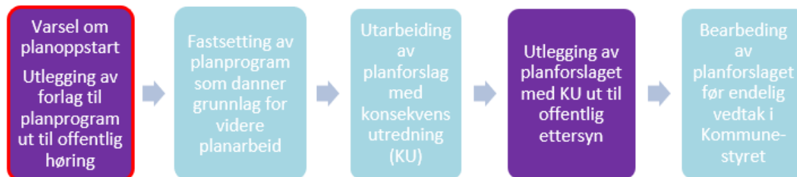
Figur 9: Flytskjema planprosess med konsekvensutredning. Lilla bokser presenterer ledd i planprosessen hvor det er mulig for berørte parter å medvirke/uttale seg. Rød innramming viser hvor en er i prosessen pr. nå.
