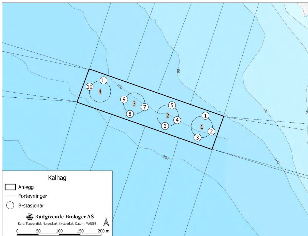
Figur 4. Oversikt over anlegget ved lokaliteten med merdnummer (grå firkantar) og plassering av grabbhogg (nummererte sirkler). Kartgrunnlaget er henta frå http://kart.fiskeridir.no .
