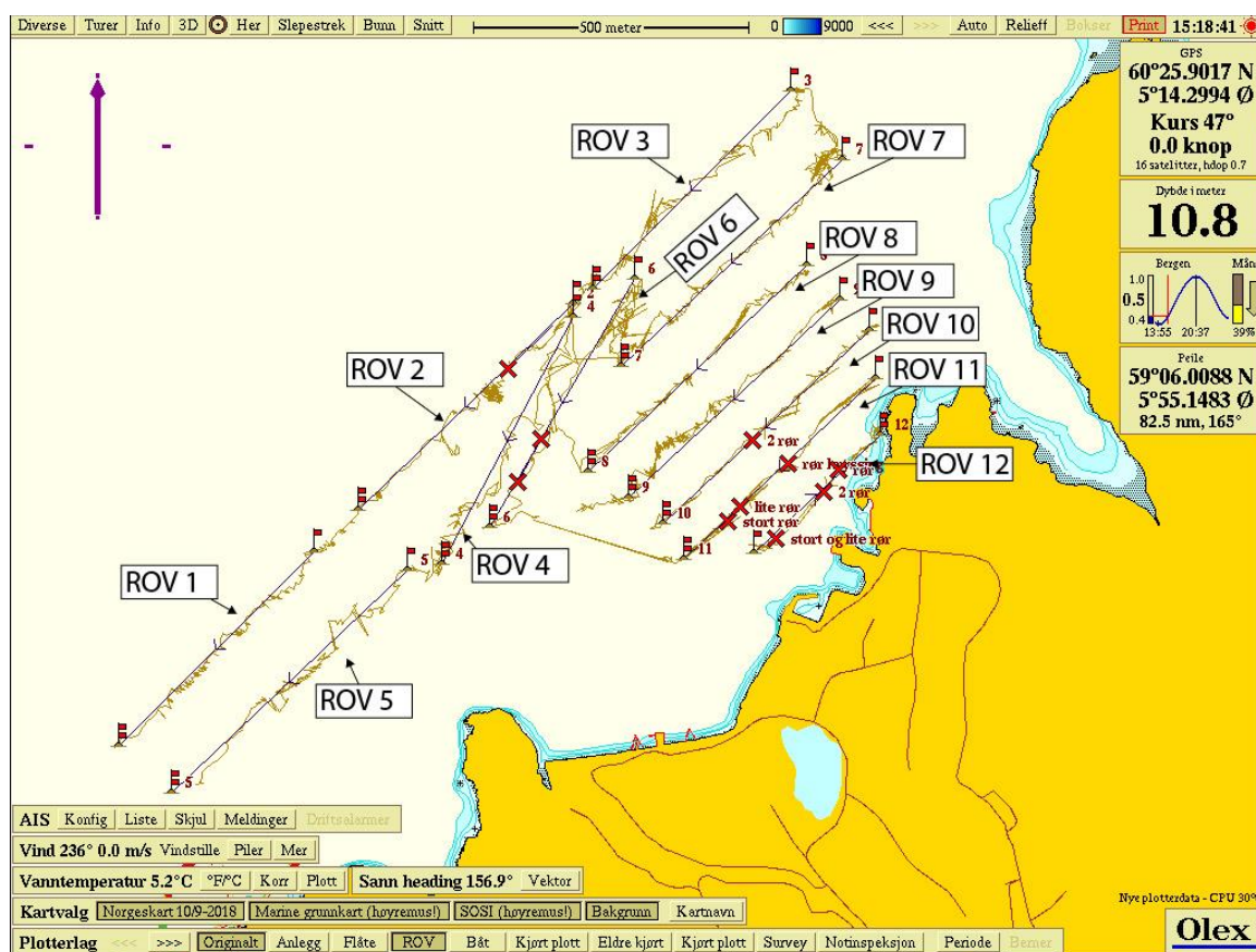
Figur 18 Kart over ROV-transekter (ROV1-ROV12). De mørke strekene mellom røde flagg indikerer planlagte ROV-transekt (rett strek). Faktiske ROV-transekt er markert i gul/oransj strek (mer buet og krøllet strek). Røde X-markeringer på grunne områder (til høyre i figuren) indikerer lokalitet der rør er observert (det ble også observert rør i ROV-linje 8 (ca 207 m dyp) og RLV-linje 9 (ca 180 m dyp), men de er ikke markert i kart, mens X-markeringene på dypere vann (midt i figuren) indikerer omtrentlig lokalitet for testområder.
