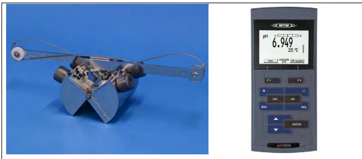
Figur 3.1. 250 cm 2 grabb frå KC-Denmark og pH3310 pH og Eh målar frå WTW.
