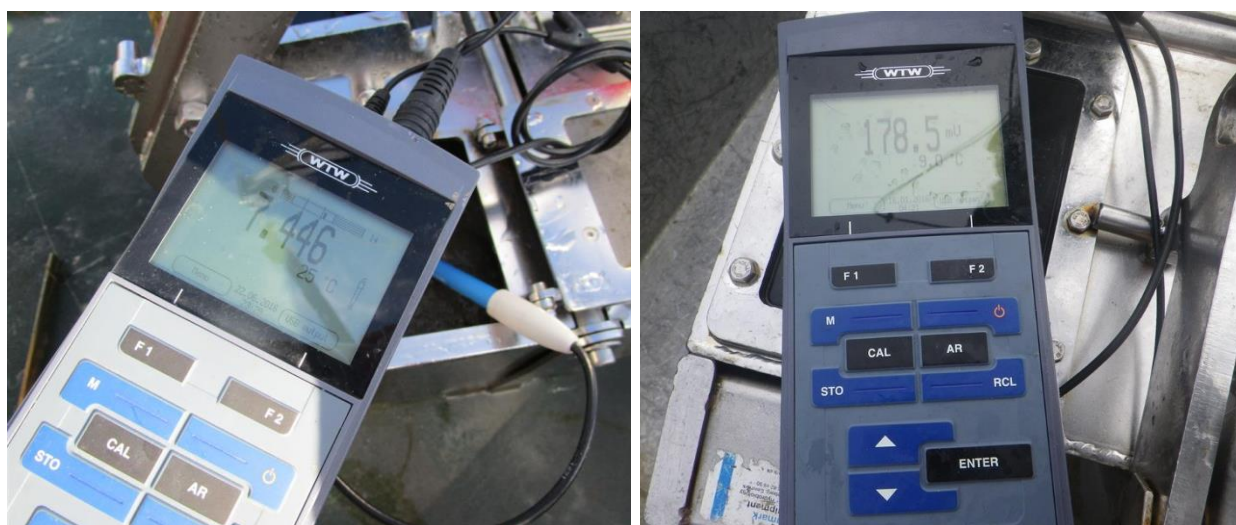
Figur 2-4. Måling av pH (til venstre) og måling av redokspotensialet (til høyre) i sedimentet.
