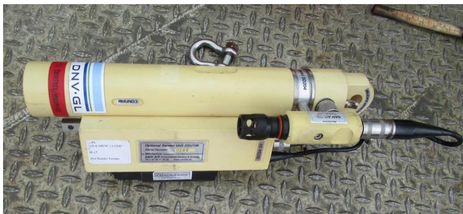
Figur 2-3. SAIV CTD 204 for måling av temperatur, saltholdighet og oksygen i vannsøylen.
