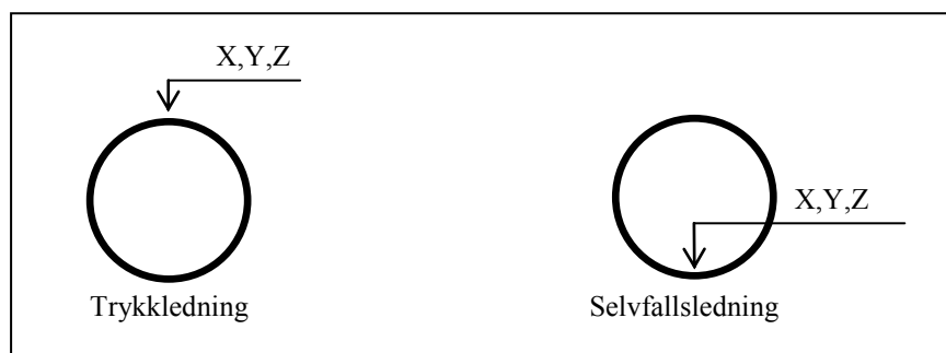
Figur 1. Måling av ledningshøyde.
